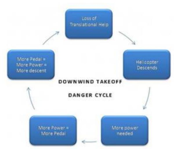
A esta altura, você tem uma velocidade em relação ao solo de 15 nós, mas o sistema rotor passa por uma corrente de ar relativa da parte dianteira de zero; você não recebe ajuda da sustentação translacional e, logo, o helicóptero começará a descer.
